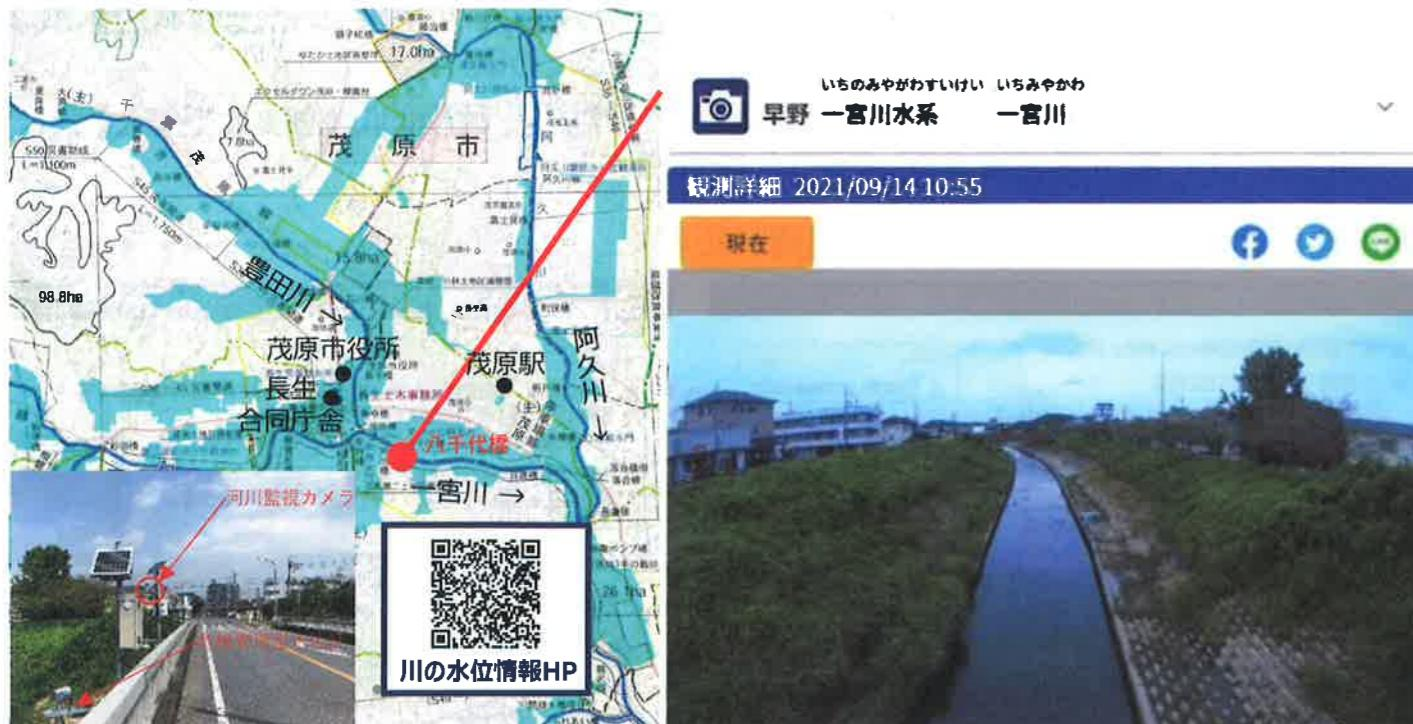
\*簡易型河川監視カメラとは、ズームや首振り機能を削除するなど機能を限定し、設置・ランニングコストを低減させたカメラです。また、カメラ映像は5分間隔で静止画をデータ送信し、上記WEBサイトで公開されています。
