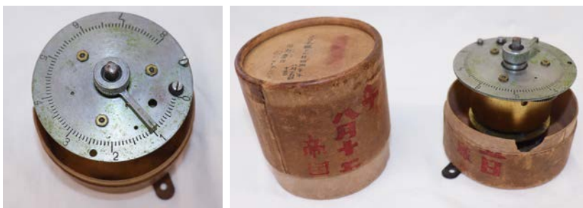
▲風船爆弾時限信管カ部分・段ボール紙 (左写真は時限信管カ部分を上から撮影したもの)
